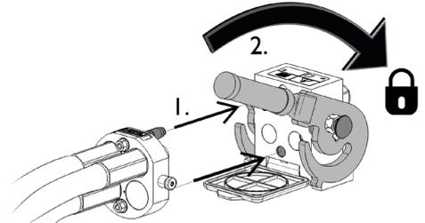
A alavanca deverá mover-se lentamente até à posição de bloqueio. Se a alavanca não deslizar com suavidade, verifique o alinhamento e a posição do conector e limpe os conectores. Desligue ainda o carregador e liberte a pressão hidráulica residual.
