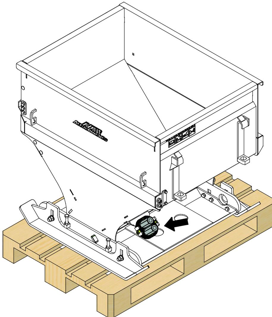
Para períodos de armazenamento mais longos oleie as partes visíveis do eixo do cilindro hidráulico para evitar danos devidos a ferrugem.
